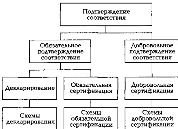
Рис. 10.1. Схема подтверждения соответствия объектов обязательным и добровольным требованиям
