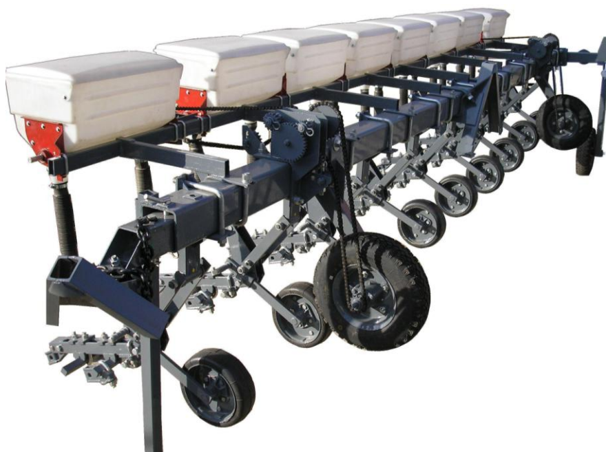
Рис. 1. Культиватор навесной для высокостебельных культур КРН-5,6В (общий вид с подкормочным приспособлением в рабочем положении)
